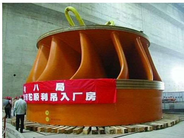
Francisove turbina za Hidroelektranu Tri klanca
